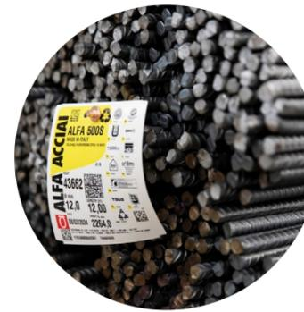
L'EPD si riferisce ai prodotti da costruzione in acciaio laminati a caldo in barre e rotoli per impieghi strutturali, realizzati nello stabilimento di Acciaierie di Sicilia, situato a Catania (Italia), con la tecnologia del forno ad arco elettrico a partire da rottame di acciaio post-consumo e pre-consumo. Le caratteristiche meccaniche omogenee e ripetibili dell'acciaio garantiscono ottime prestazioni in qualsiasi tipo di costruzione e area geografica, poiché hanno un'elevata duttilità.
